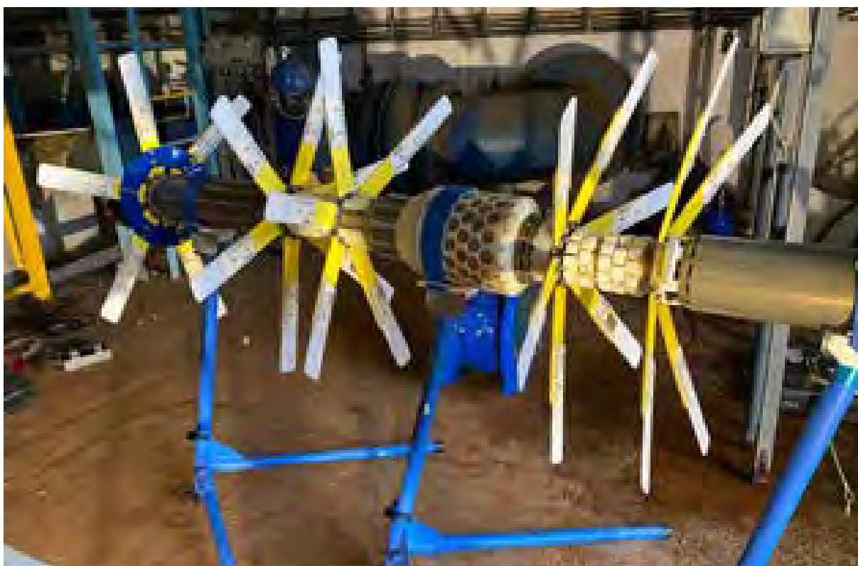
▪ Speciální inspekční sestava PipeDiver před zahájením diagnostiky vodovodního přivaděče u Hostouně.
