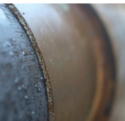
Tato metoda se používá převážně pro sanaci starého ocelového nebo litinového potrubí s rozsáhlou korozí. Sanované potrubí musí být mimo provoz a bez vody.
